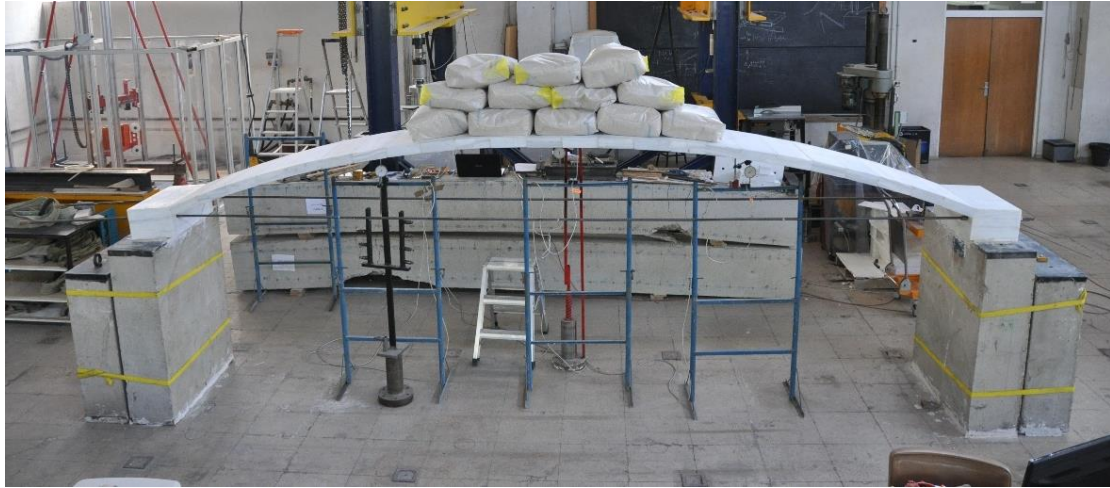
Figura 1. Bóveda pretensada y cargada.
