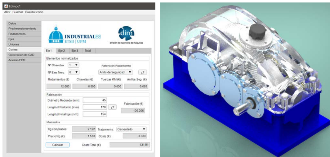
Figura 2. Izquierda - Ejemplo de pantalla del programa EDIMPO. Derecha – CAD del reductor diseñado por los alumnos
