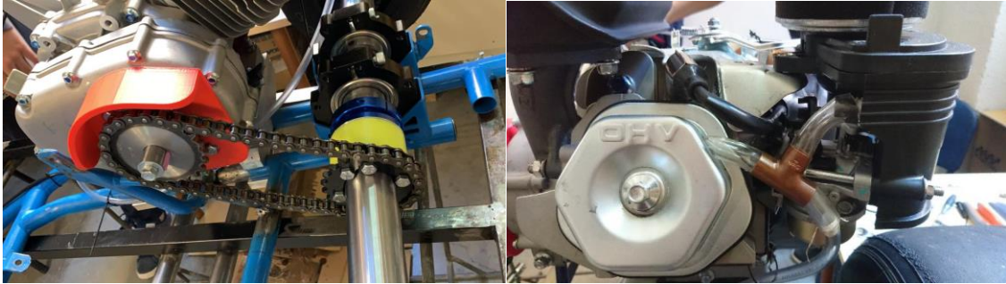
Figura 1: Montaje de la transmisión y aporte de gasolina con bomba de vacío
