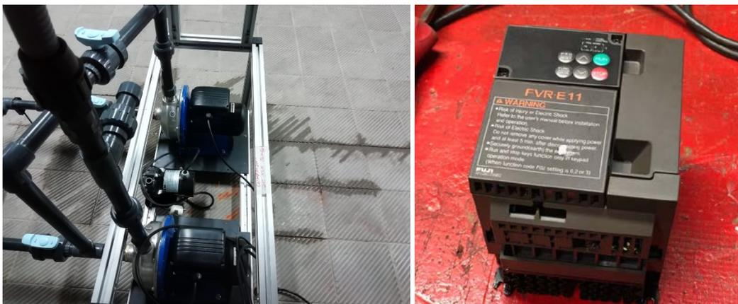
**Figura 2.** Vista del sistema de bombeo del canal y variador de frecuencia
