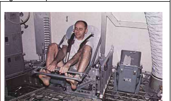
Figura 5 Medición del peso mediante un dispositivo oscilatorio en ausencia de gravedad.
