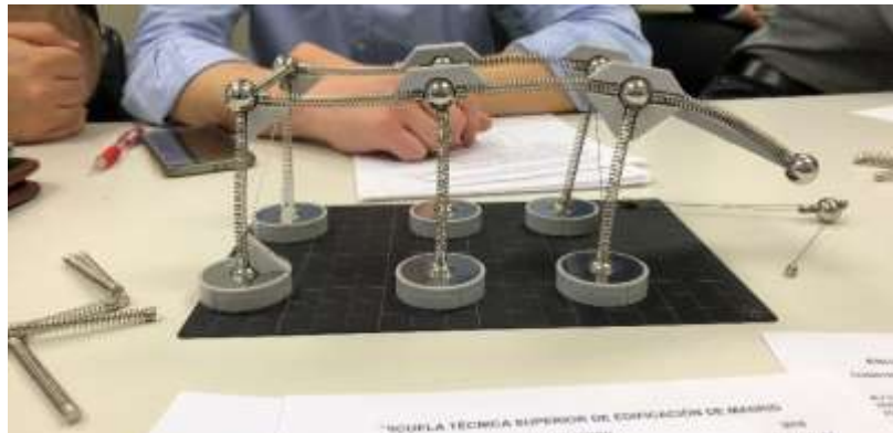
Figura6. Modelado de vigas continuas.
