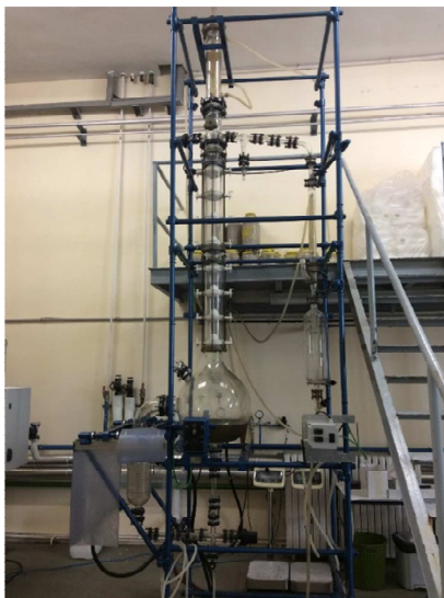
Figura 1. Columna de destilación instalada en la planta piloto de Tecnología Química de la ETSI Industriales-Castellana.
