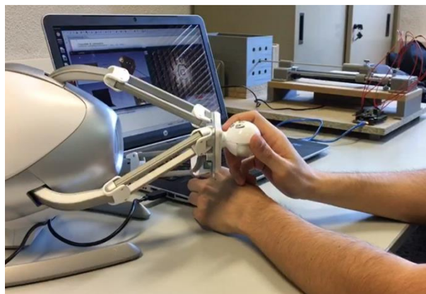
Figura 2. Novint Falcon, en primer plano, con el sistema robótico y el phantom en segundo plano.
